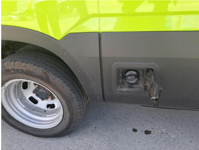
Bilde 3: Påfylling tilleggsvarmere
