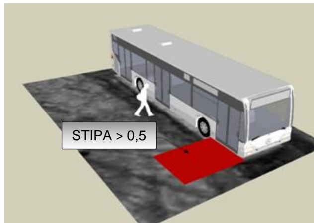
Figur 4 – Illustrasjon av nedslagsfelt for talemeldinger der STIPA > 0,5 gjelder (rødt felt), her vist ved dør 1. (Ill: Region Stockholm).
