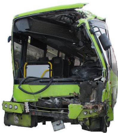
Figur 3: Skader i front på østgående buss. Foto: SHT
