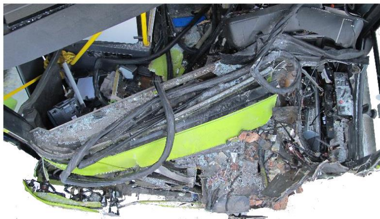
Figur 4: Deformasjoner på førerplass i østgående buss sett ovenfra. Foto: SHT
