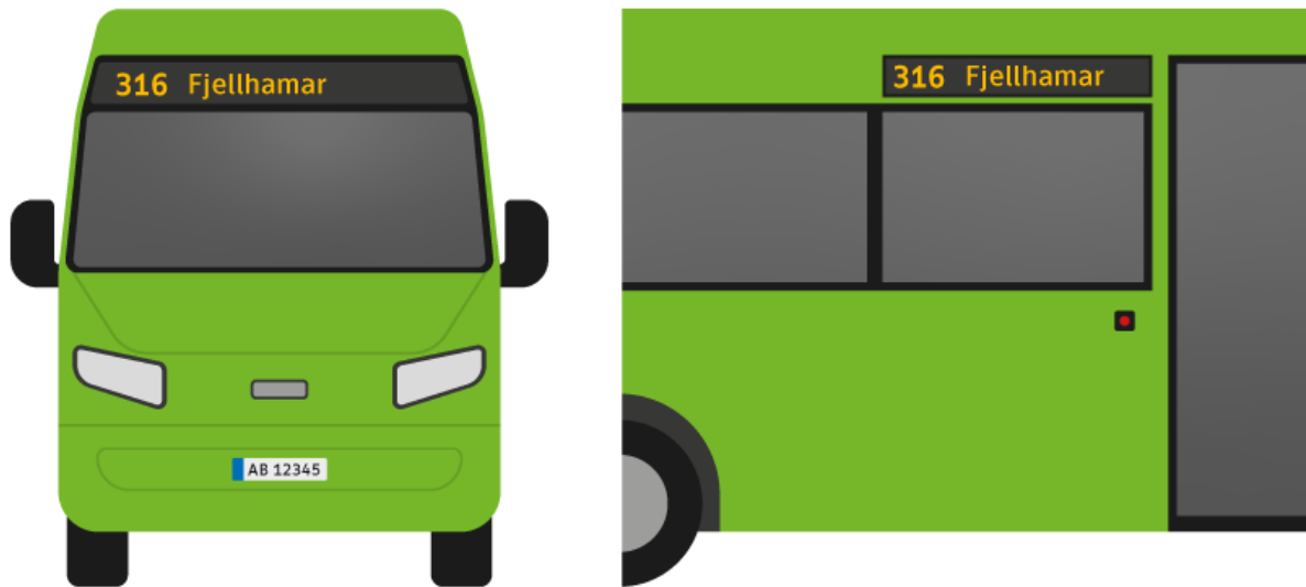
Figur 1 – Illustrasjon av skiltkasse med krav til minimum skrifthøyde henholdsvis foran (venstre) og sidene og bak (høyre).
