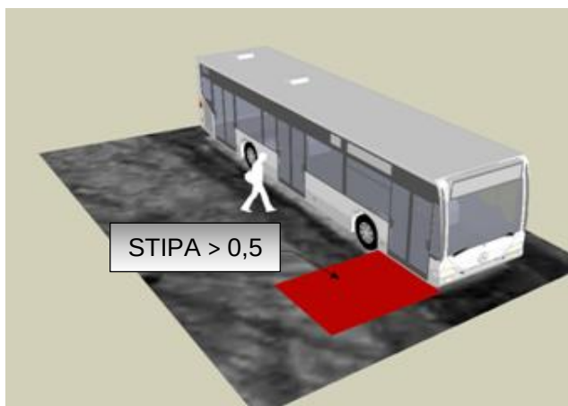
Figur 10 – Illustrasjon av nedslagsfelt for talemeldinger der STIPA > 0,5 gjelder (rødt felt), her vist ved dør 1. (Ill: Region Stockholm).
