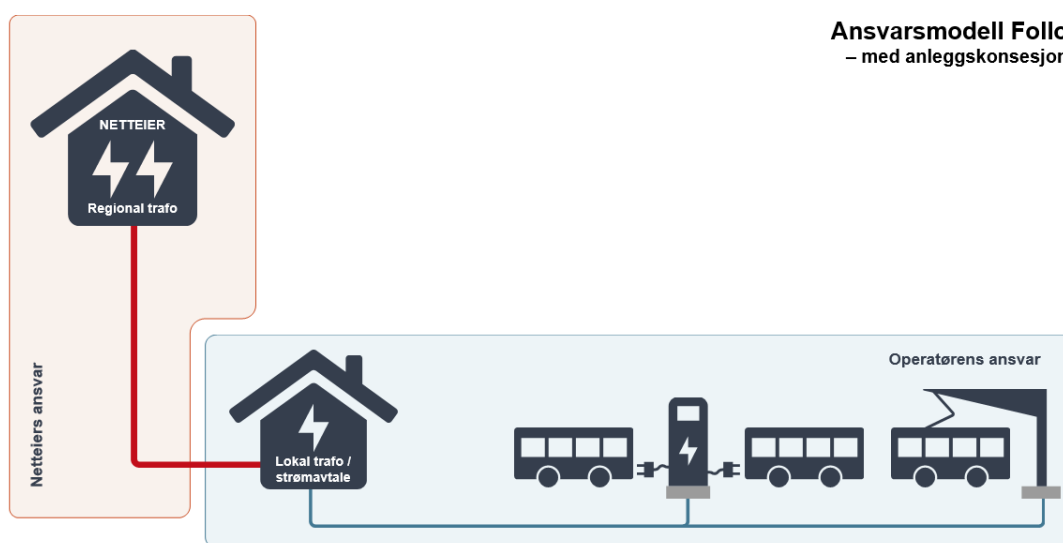
Figur 1 – Ansvarsmodell med levering på høyspenning 22kV (– med anleggskonsesjon)
