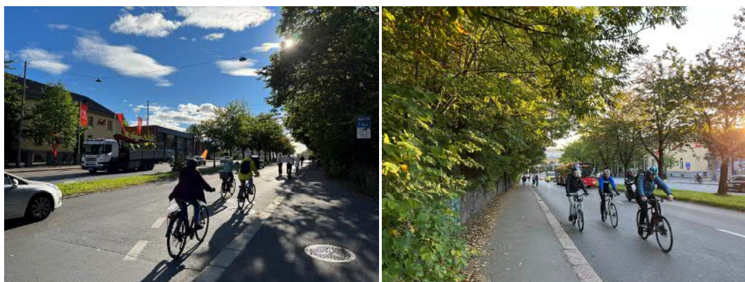
Figur 45: Ved Vestre Aker kirke er det kollektivfelt, men det er ikke plass til sykkelfelt. Når det er mange syklist i kollektivfeltet kjører bussene i bilfeltet ved siden av, noe som gir uforutsigbar avvikling for bussen. (Foto: Sweco).
