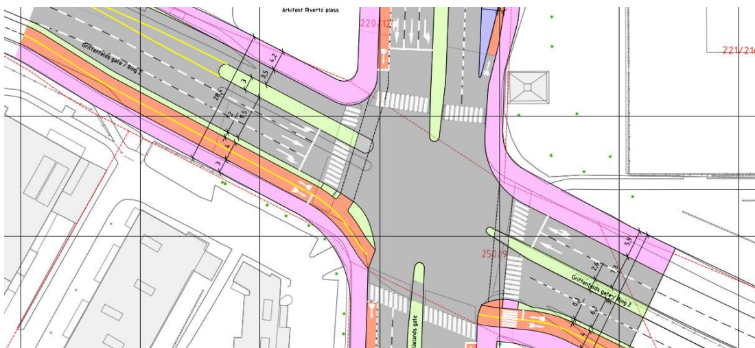
Figur 73: For å bedre avviklingen i kryssene er det etablert venstresving forbudt på Ring 2 der Kirkeveien møter Suhms gate, Blindernveien, Sognsveien og Kierschows gate (retning øst). Arkitekt Rivertz' plass bygges om til å gi svingmulighet til venstre for biler som kommer fra vest. Det er etablert et langt venstresvingefelt. I krysset er det også etablert et høyresvingefelt med signalfase for biler fra vest som skal ned Uelands gate.
