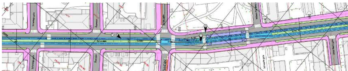
Figur 71: Midtstilt separat sporvogntrasé ved Marienlyst. Venstresvingefelt for bil i Suhms gate er fjernet.
