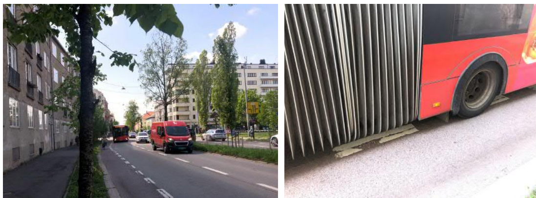
Figur 16: Det er smale sykkelfelt, kollektivfelt og kjørefelt for bil på deler av Ring 2. Når det er biler ved siden av bussen, legger bussen seg inn i sykkelfeltet. Bildet viser strekning mellom Majorstuen og Marienlyst (foto: Sweco).
