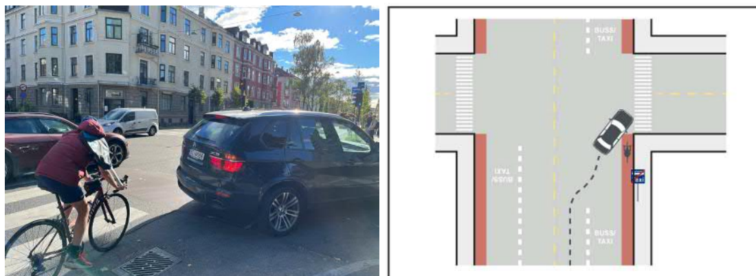
Figur 15: Sykkelfelt fører til konflikter mellom kjøretøy som skal svinge til høyre av Ring 2, og syklister i sykkelfeltet (foto: Sweco).
