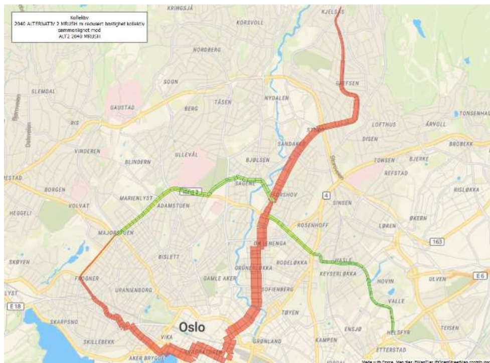
Figur 121: Sammenligning A2 Sporvogn med redusert hastighet mot A2 Sporvogn, morgenrush begge retninger i 2040. Grønn farge er økt utnyttelse mens rød er redusert utnyttelse. Kilde: RTM 23+
