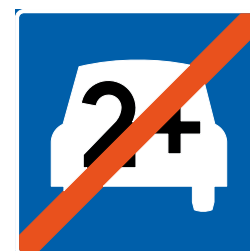
Figur 2.6. Skilt 511 Slutt på sambruksfelt. Illustrasjon hentet fra Skiltforskriften[5].
