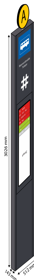
Figur 1.39. Standard søyle er 0,51 meter bred med 0,7 meter bredt fundament. Det finnes også en søyle som er 0,64 meter bred.
