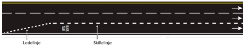
Figur 2.9. Oppmerking ved starten av kollektivfelt, på strekning utenfor veikryss. Illustrasjon fra Statens vegvesens N302 Vegoppmerking [7].
