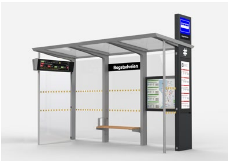
Figur 1.37. Standard tremoduls lehus uten reklame med lengde ca. 4,5 meter. Illustrasjon: UIP.
