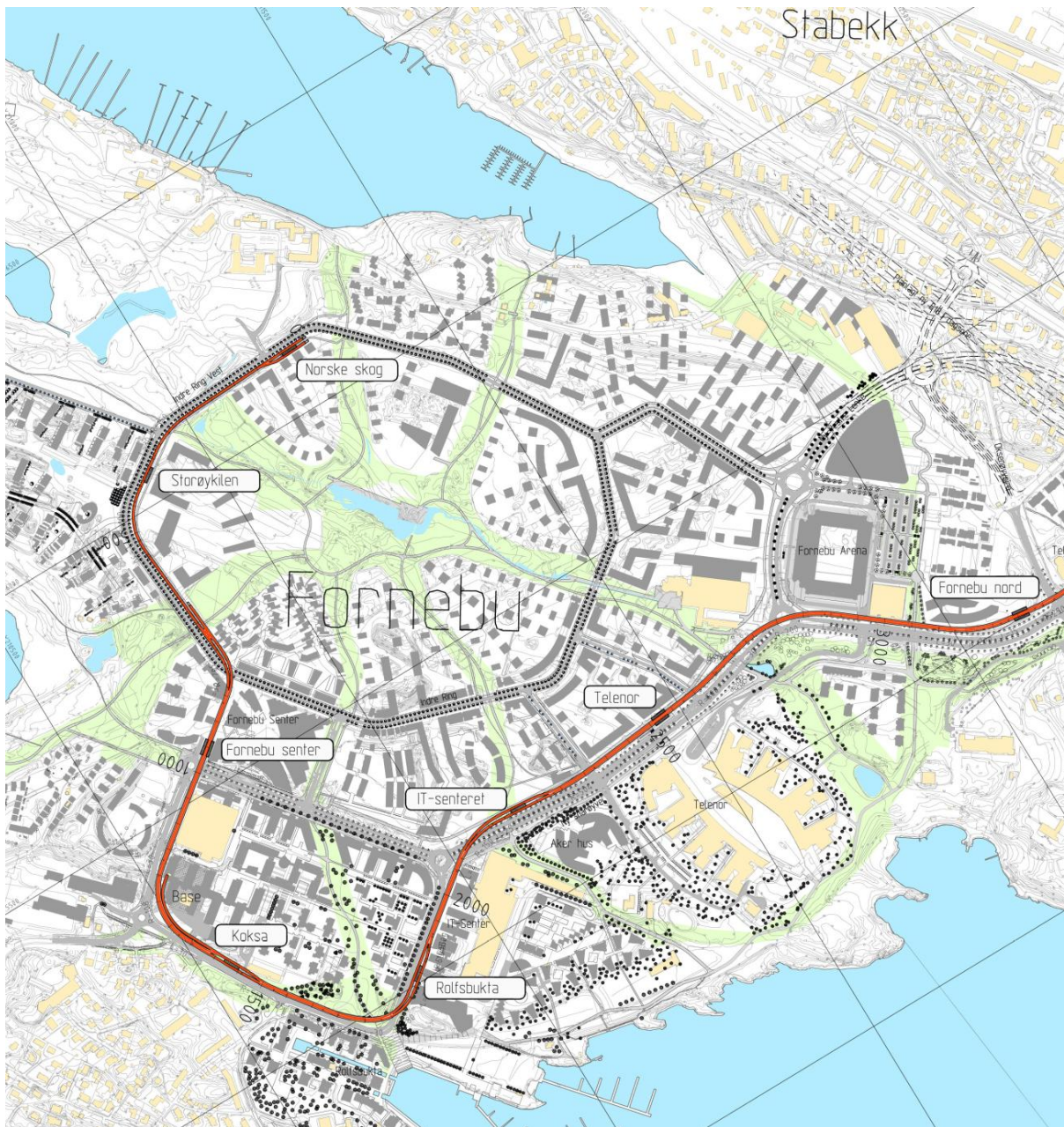
Figur 4.10. Regulert trasé for automatbanen på Fornebu
