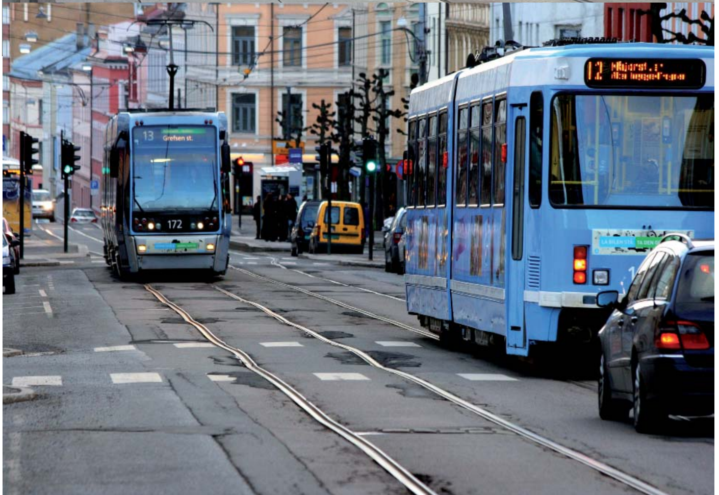
SL95 ga økt slitasje i kurven ved Aker brygge, og alt tyder på at et dårlig spor forfaller raskere ved trafikk med SL95 enn SL79. Nederst: Spor i dårlig forfatning på Torshov.
