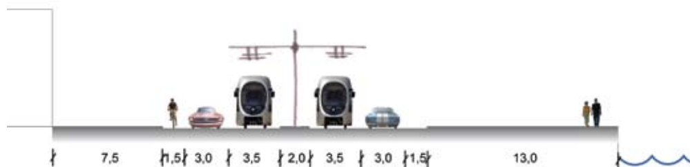
Snitt 7A: Alternativ 5B midtstilt trikk i Langkaigata
