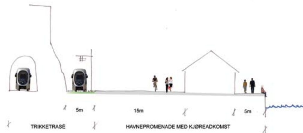
Snitt Akershusstranda med trikk gjennom tunnel (alt 1a).
