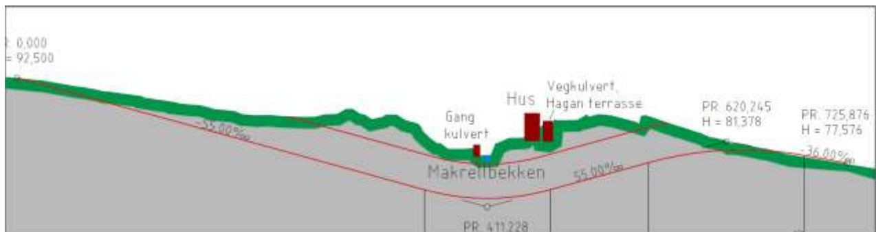
Figur 33: Planskilt kryssing ved Makrellbekken (lengdeprofil)
