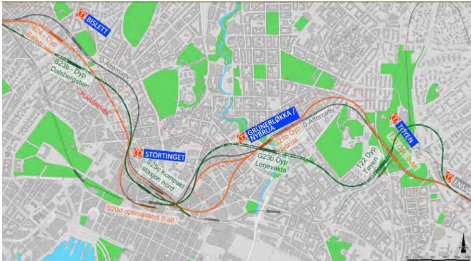
Figur 48: Trasealternativer for ny T-banetunnel. Hovedalternativ 1 er vist i grønt og er lagt til grunn for analysen (Kilde: Norconsult 12 ).
