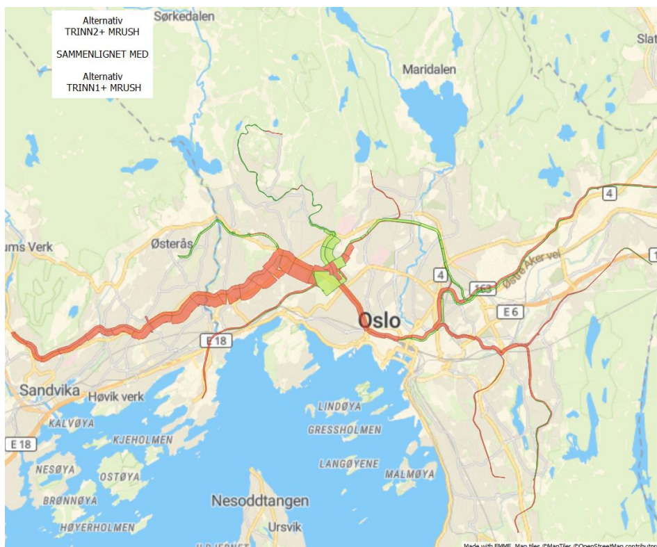
Figur 45: Endring i trafikk på T-banen i Trinn 2+ sammenliknet med referansen Trinn 1+, morgenrush 2040. Rødt betyr flere reisende og grønt betyr færre reisende (kilde: RTM23+).
