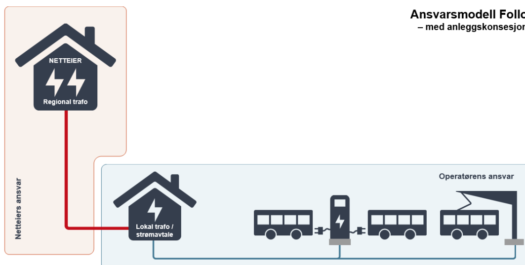
Figur 1 – Ansvarsmodell med levering på høyspenning 22kV (– med anleggskonsesjon)
