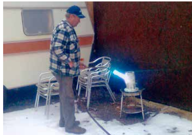
Frank varmer opp akselflens på en helt spesiell måte; den skal være så varm at når man spytter på den skal det frese, ikke koke...
