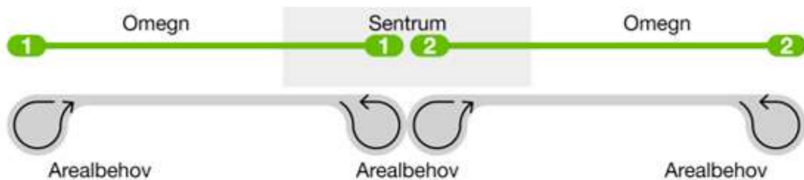
Figur 5.1. Dersom busser må snu og/eller regulere i sentrum kreves det både arealer ved endestopp og i sentrumsområder. Ofte er det arealknapphet i sentrumsområdene. Illustrasjon fra HiTrans Best practice guide. Public transport - Planning the networks.
