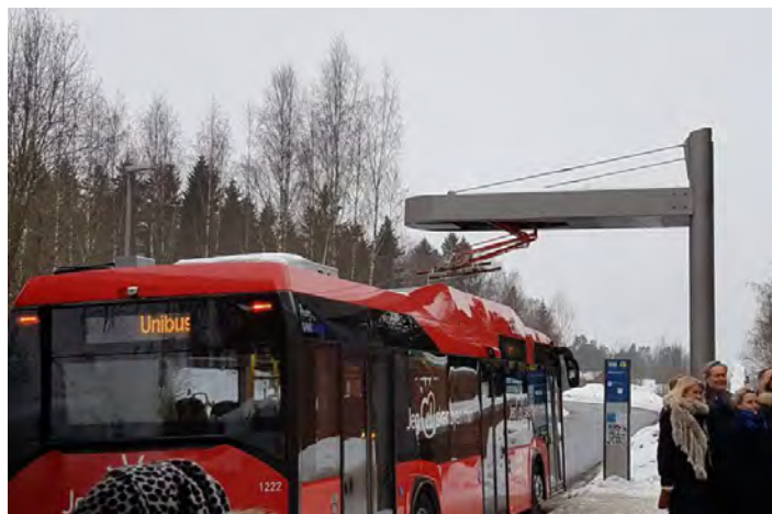
Bilde 2: Elbuslader med pantograf på endeholdeplass på Mortensrud (Foto: Olav Stanly Kyrvestad)
